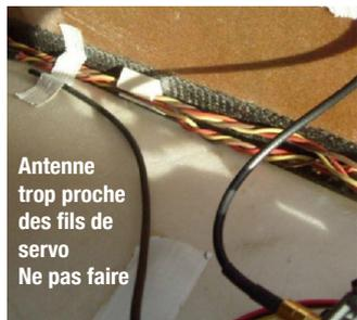
Antenne trop proche des fils de servo
