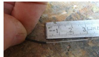
Couper les fils fins de la gaine au ras du souplisseau plastique de recouvrement.
