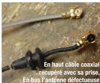
En haut câble coaxial récupéré avec sa prise, En bas l'antenne défectueuse
